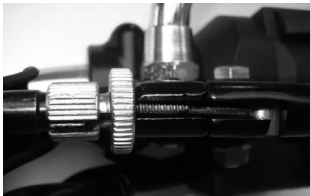
AJUSTADOR E CONTRAPORCA POSICIONADOS CORRETAMENTE
