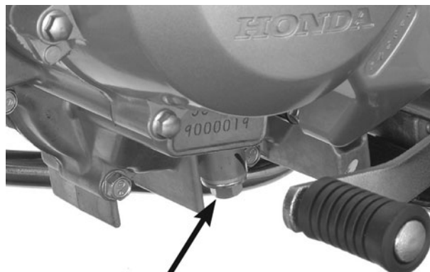
BUJÃO DE DRENAGEM/ARRUELA DE VEDAÇÃO TAMPA DE ABASTECIMENTO/VARETA DE MEDIÇÃO
