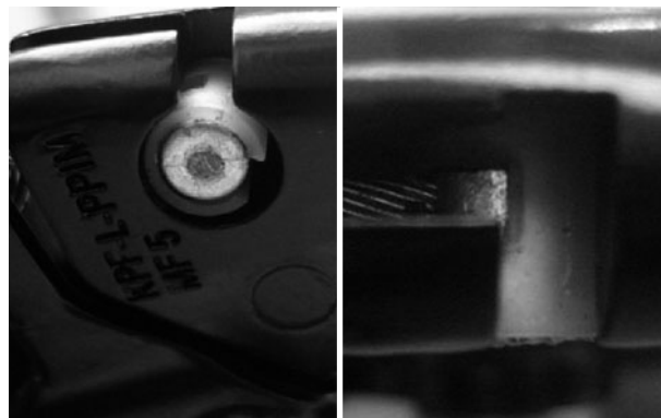
EXTREMIDADE DO CABO POSICIONADA CORRETAMENTE NA ALAVANCA DE EMBREAGEM
