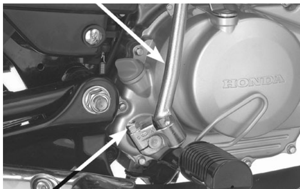
PARAFUSO DE FIXAÇÃO BRACO DE ACIONAMENTO SUPORTE DO CABO CABO DA EMBREAGEM
